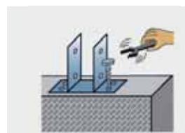
Visser le pied d'ancrage
