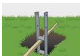
Le trou dans la terre (env. 30 x 30 x 50 cm) placer l'ancre au centre et stabiliser
