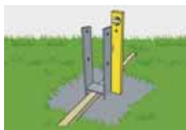
einbetonieren, ausrichten und aushärten lassen
